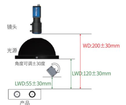
模组PACK工艺段 | 电芯大包装上料CCD系统
