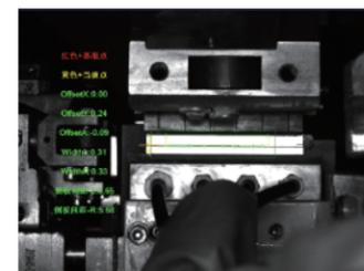
模组PACK工艺段 | 底膜位置度CCD检测系统
